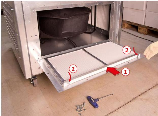
Abb. 13 Ausblasdämpfer einsetzen
