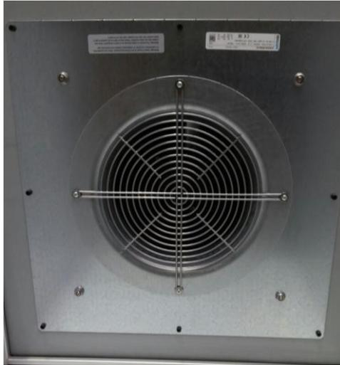
Abb. 4 Schutzgitter Ventilator
