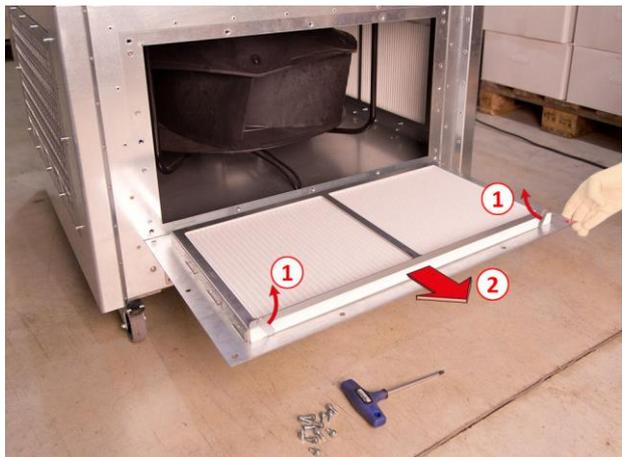
Abb. 12 Ausblasdämpfer entnehmen
