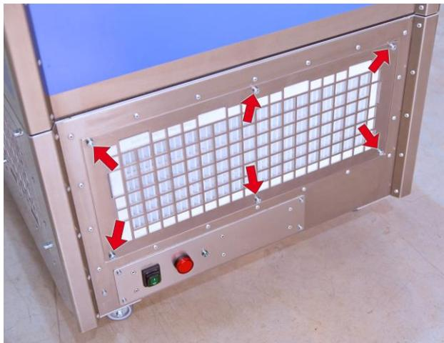
Abb. 11 Abdeckung lösen
